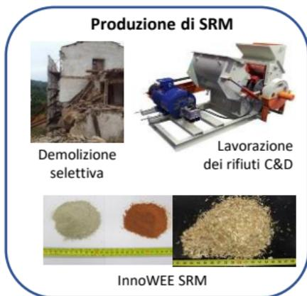
Utilizzo combinato di SRM e di **tecnologia geopolimerica** per **produrre nuovi pannelli isolanti e radianti** con **elevato contenuto di rifiuti C&D** per **migliorare le prestazioni degli edifici**.
